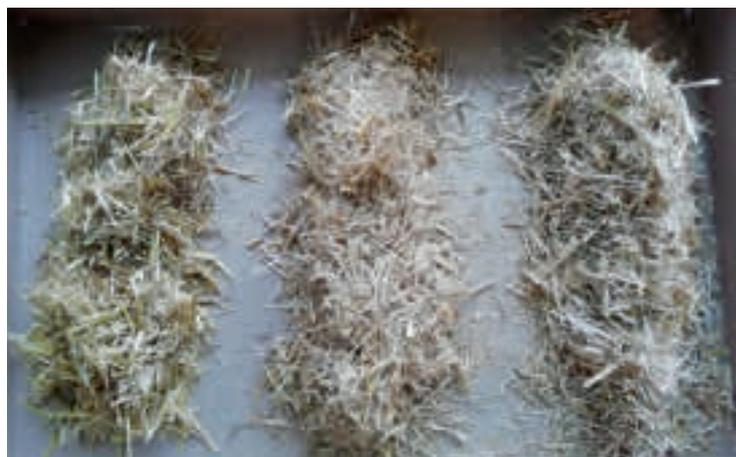
Abb. 2: Vergleich verschiedener Zerkleinerungsverfahren v.l. Strohmühle 1, Strohmühle 2, Vorbauhäcksler
