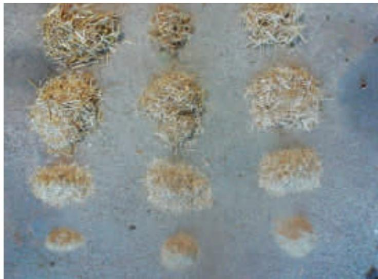
Abb. 1: Siebanalyse der Ergebnisse verschiedener Zerkleinerungsverfahren v.l. Strohmühle 1, Strohmühle 2, Vorbauhäcksler
